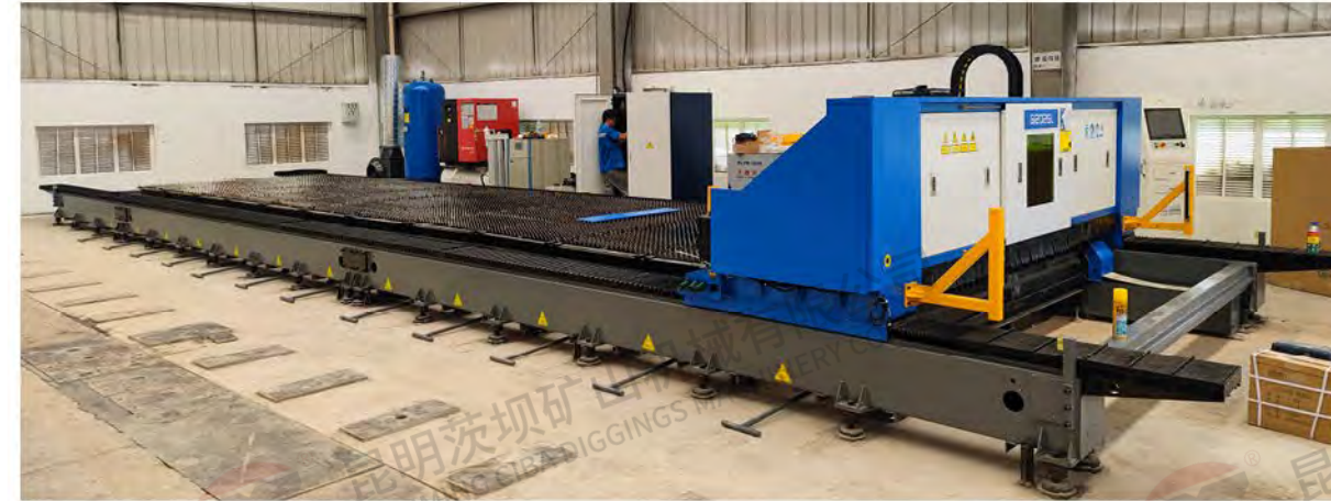
功率: 12000W, 工作台: 2500×12000 大幅面激光切割机
