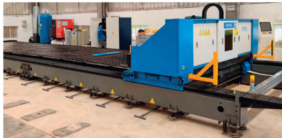
>>> 功率：12000W，工作台：2500×12000 大幅面激光切割机
