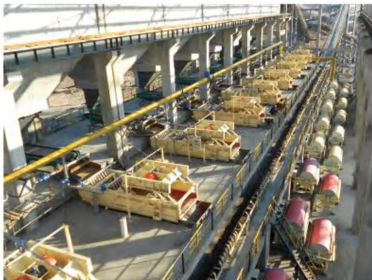
新疆省坤铭铁矿600万吨/年选厂现场。十台GK的STM-S1849与高压对辊磨机闭路筛分。
